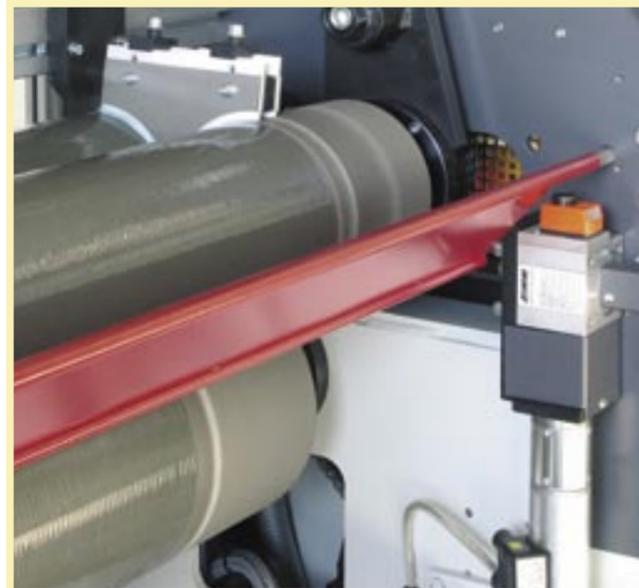
In Kombination mit einer raffinierten Transporttechnik ist es möglich, das Material in einem Arbeitsgang auf beiden Seiten zu beschichten. Diese Anlage arbeitet sehr effektiv, da Lücken im Materialfluss keinen Einfluss auf die Auftragsqualität haben.
