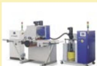
WLA500 als stand alone Anlage. Die Klebstoffzuführung erfolgt kontinuierlich mit dem Fassschmelzer FS20 für 20l-Gebinde.
