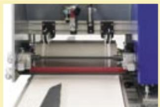
WLA500 mit Transportband als flexible und kostengünstige Lösung für die Beschichtung von textilen Einzelzuschnitten mittels Trägerblechen.
