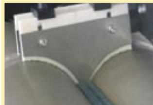
Mit zwei federgespannten Rakeln wird von Hand die Breite des Klebstoffauftrags stufenlos eingestellt.
