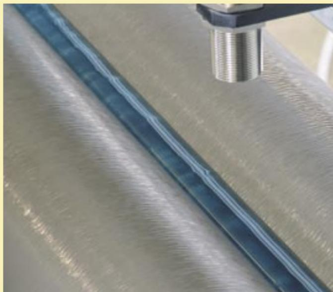
Zwischen die beheizten Walzen wird eine definierbare Klebermenge gefördert. Über den Abstand der beiden Walzen lässt sich per Spindelverstellung die Auftragsmenge einrichten. Mit einem Sensor wird die Klebermenge kontinuierlich überwacht.
